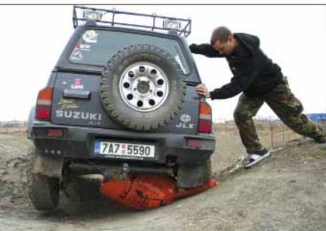
Lidská síla a nasměrování vaku posunou Vitaru Zvednutí předku, tentokrát kolmo vzhůru lehce do boku
