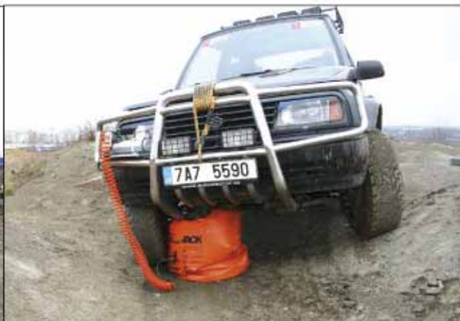
Lidská síla a nasměrování vaku posunou Vitaru Zvednutí předku, tentokrát kolmo vzhůru lehce do boku
